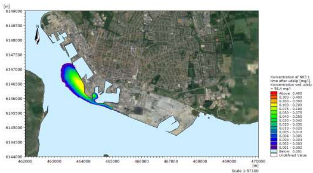
Figur 4-9. Lækagespredning ved en lækage af den maksimale koncentration af \text{NH}_3 på 96,4 mg/l vist 0,5 time efter lækage, når lækagen sker i forbindelse med ebbe (udadgående strøm, sommerscenarie).
