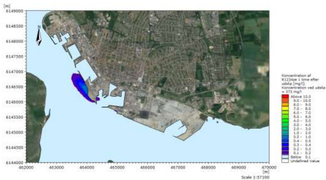
Figur 4-6. Lækagespredning ved en lækage af den maksimale koncentration af R-1234ze(E) på 373 mg/l vist 1 time efter lækage, når lækagen sker i forbindelse med ebbe (udadgående strøm, sommerscenarie).
