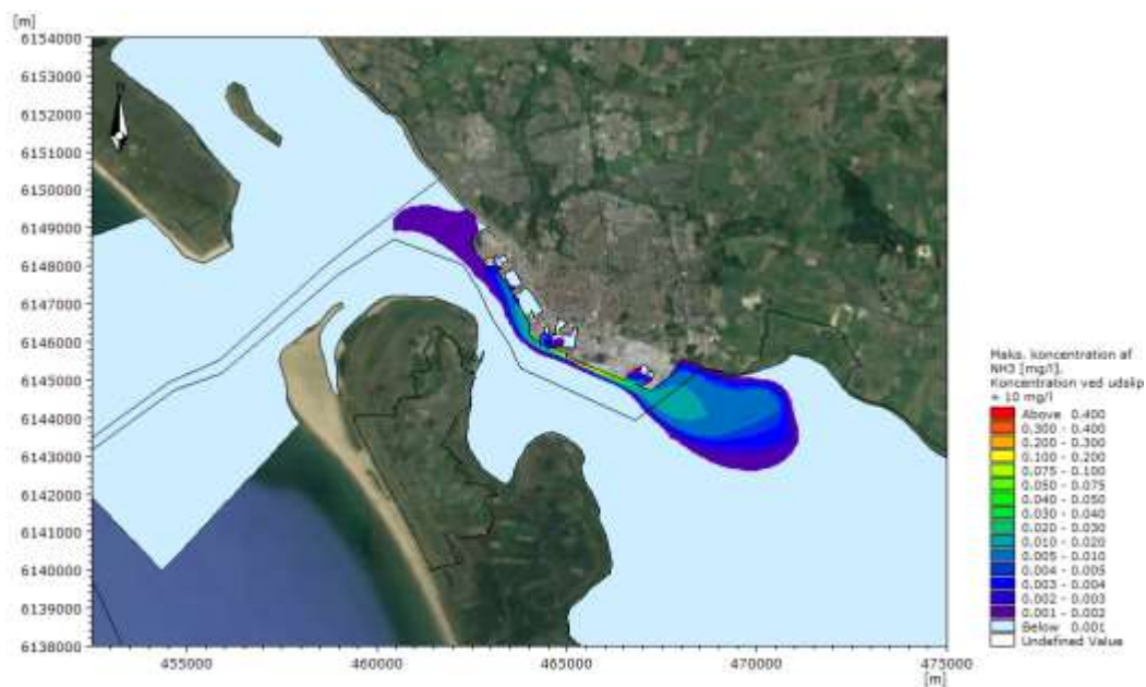
Figur 4-13. Udbredelse af \text{NH}_3 og maksimalt opnåede koncentrationer i løbet af en simuleringsperiode på 14 dage for de seks scenarier samlet, når der analyseres en lækage af \text{NH}_3 på 10 mg/l, hvor lækagen varer 6 minutter. Bemærk, at det ikke er et øjeblikbillede af udbredelsen af \text{NH}_3 .
