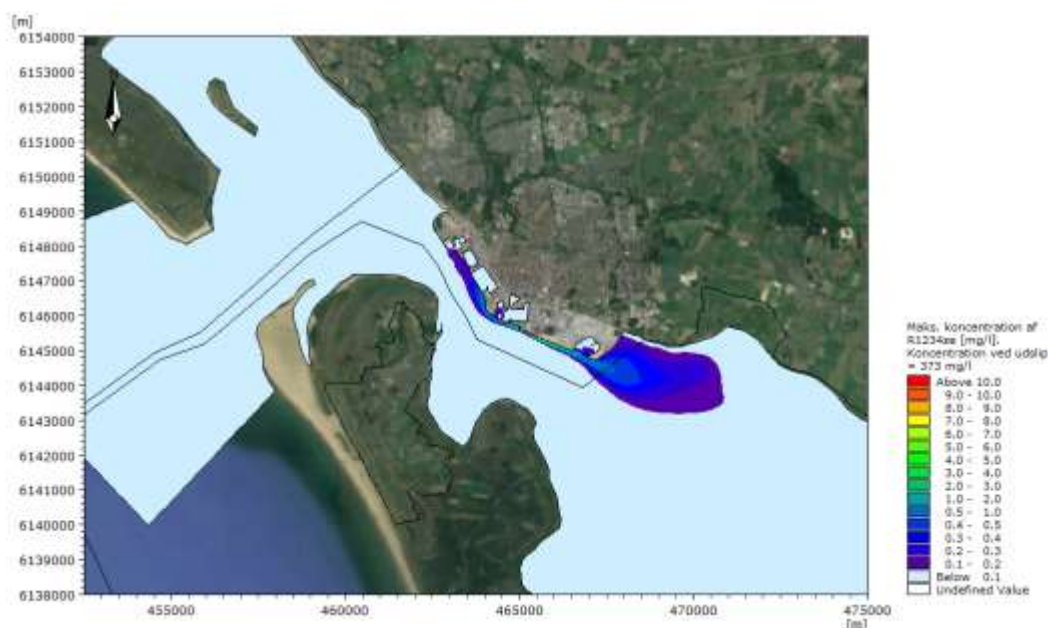
Figur 4-4. Udbredelse af R-1234ze(E) og maksimalt opnåede koncentrationer i løbet af en simuleringsperiode på 14 dage for de seks scenarier samlet, når der analyseres en lækage af R-1234ze(E) på 373 mg/l hvor lækagen varer 6 minutter. Bemærk, at det ikke er et øjeblikbillede af udbredelsen af R-1234ze(E).
